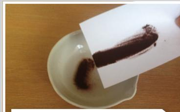
Насыпают протаргол тонким слоем на поверхность воды
