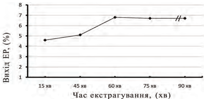
Рис. 3. Залежність виходу ЕР (%) з вичавок м'якоти гарбуза від часу екстрагування
