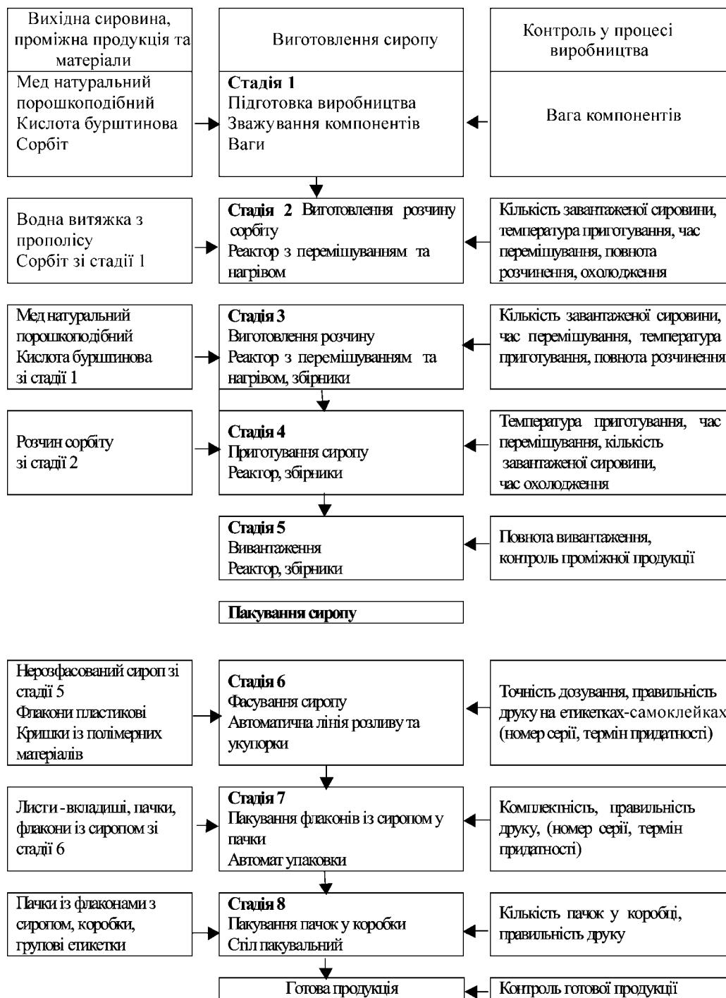
Рис. 2. Технологічна схема виробництва сиропу "Прополіс-ЛМ".
