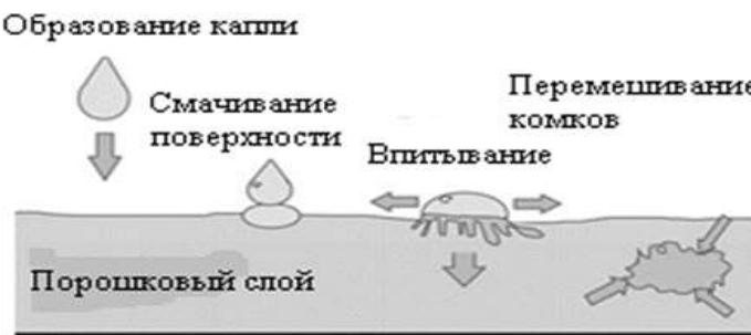
Рисунок 1 - Увлажнение и образование зародышей гранул в брызговой зоне гранулятора.
