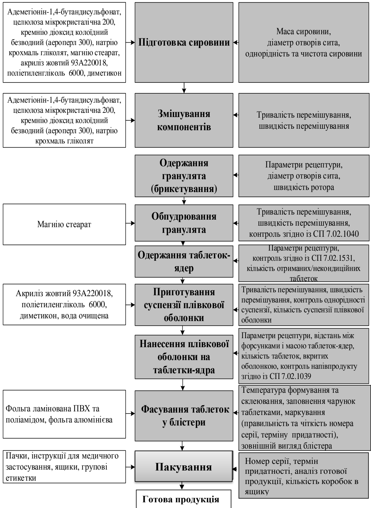
Рис. 4 Технологічна схема виробництва таблеток з адеметіоніном
