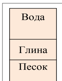
Рисунок 1. Схема распределения фракций при отмучивании глины в реакторе
