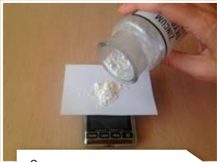
Отвешивают цинка оксид
