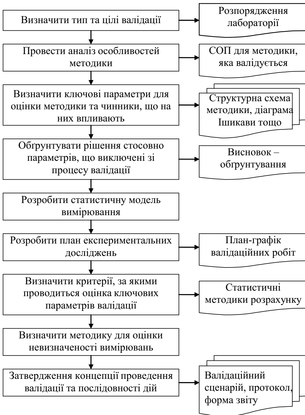
Рис.1. Блок-схема валідаційного майстер-плану для оцінки придатності біоаналітичних методик для фармакологічних досліджень ЛЗ.
