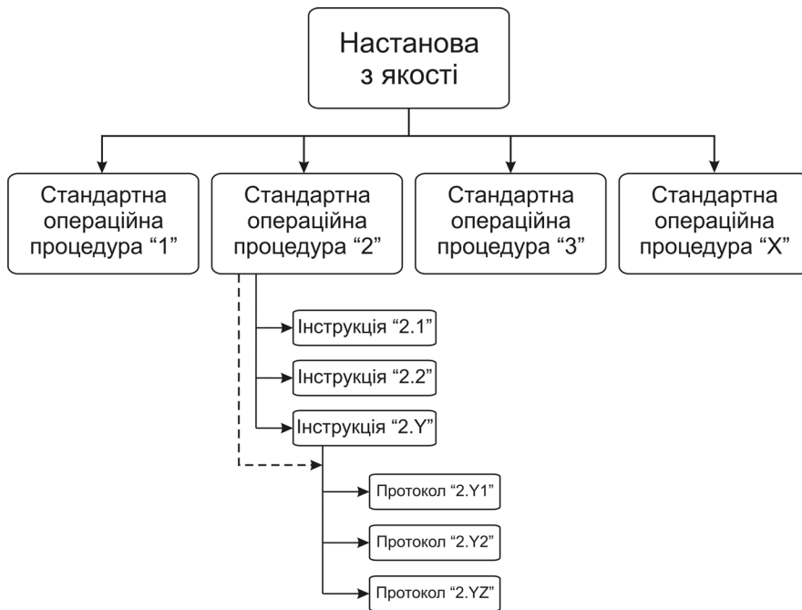
Рис. 1. Ієрархія документів системи забезпечення якості випробувальної лабораторії
