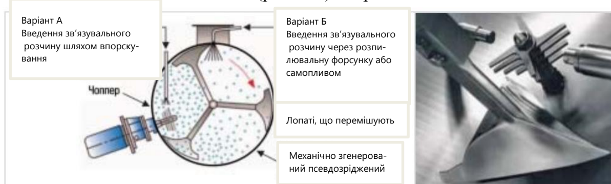
Рис. 2.9. Принципова схема робочої частини горизонтального змішувача-гранулятора з високим зусиллям зсуву (ліворуч) і фотографія лопаті, що перемішує, чопера і штуцера для подачі зволожувача (праворуч) (L dige, Німеччина)
