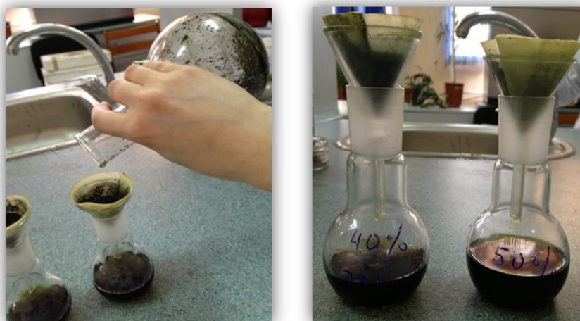
Рис. 1. Фильтрование 1-го экстракта
