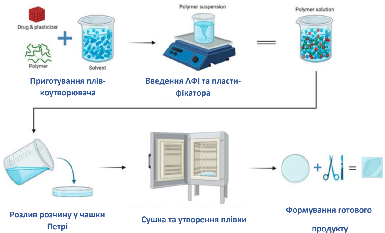
Рисунок 3.3. Схема одержання плівок методом лиття з розчинника.
