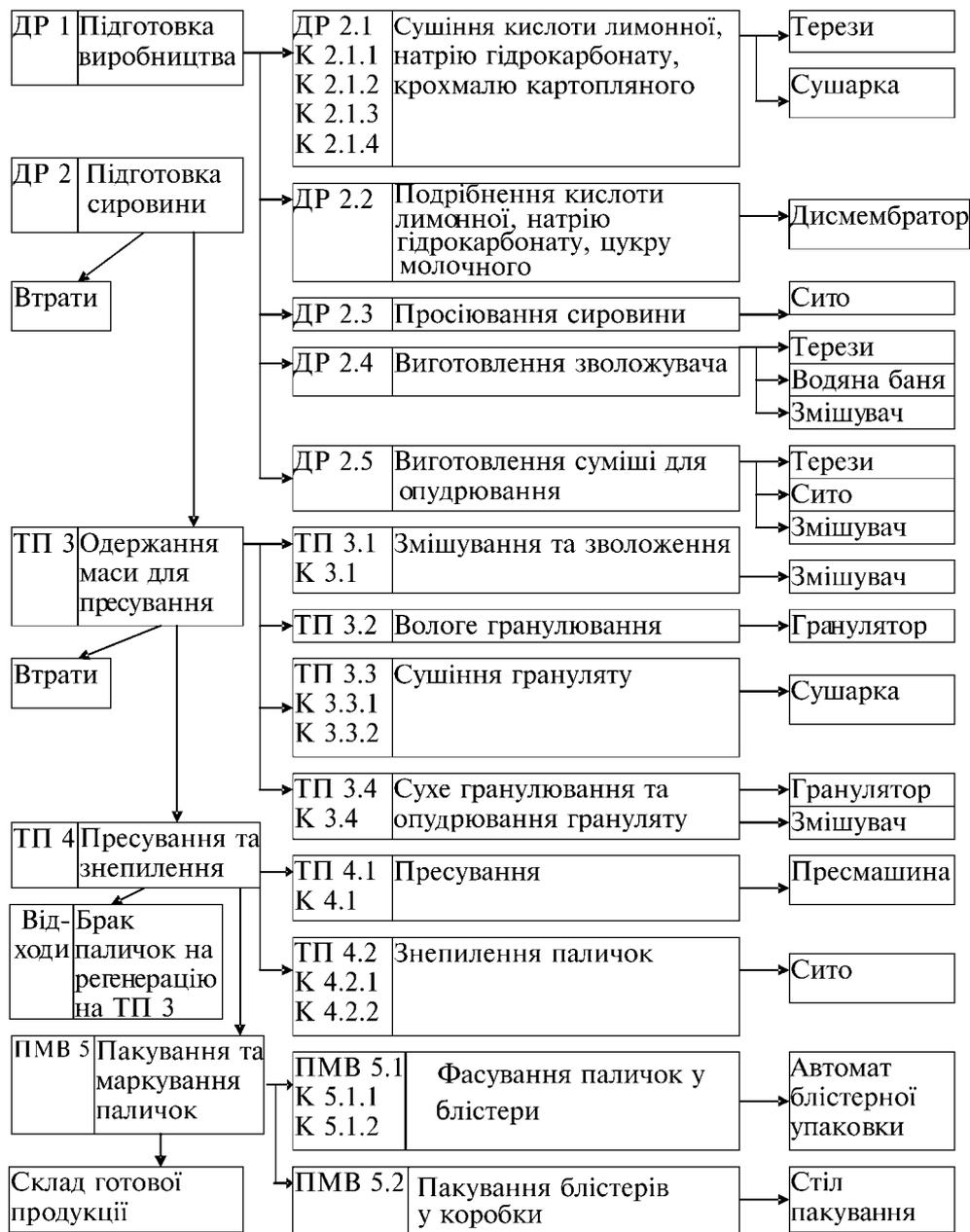
Рис. Блок-схема технологічного процесу виробництва піноутворюючих паличок.
