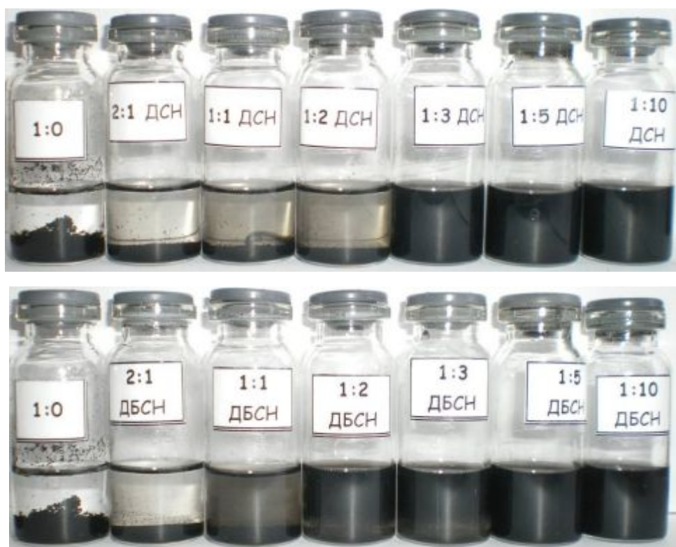
Рис.2. Дисперсия углеродных нанотрубок стабилизированная натрий додецилсульфонатом (ДСН) (вверху) и натрий додецилбензенсульфонатом (ДБСН) (внизу) в зависимости от массового соотношения (через 30 дней)
