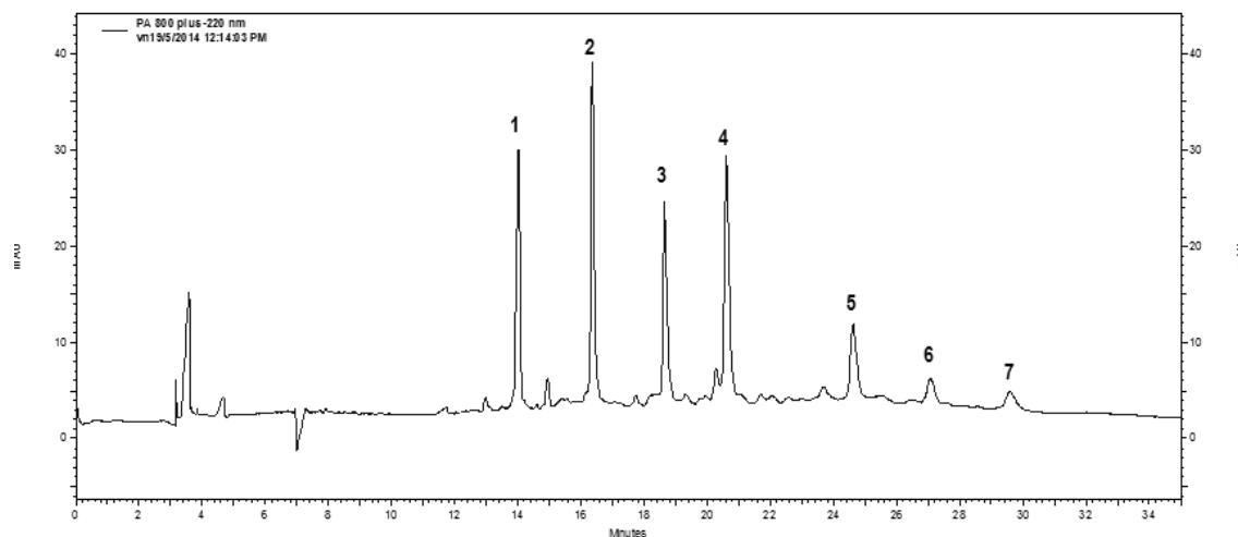
**a)** Типова електрофореграма розподілу маркерів молекулярної ваги SDS-MW Cat.N# A51970AC (Beckman Coulter, Inc.) (1.-10 кДа, 2.- 20 кДа; 3.- 35 кДа; 4.-50 кДа; 5.-100 кДа, 6.-150 кДа; 7.- 225 кДа).
