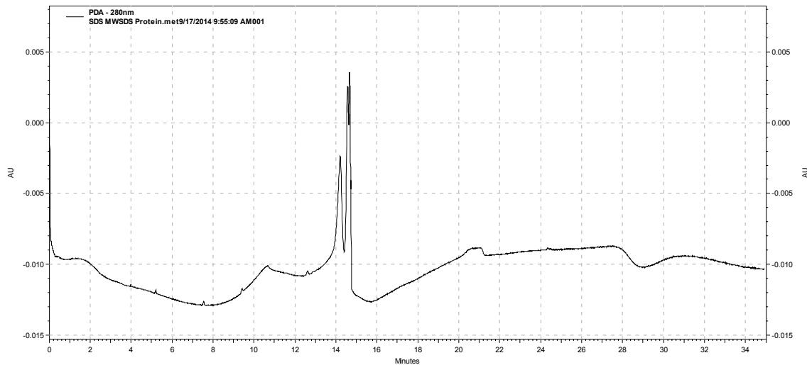
**b) Електрофореграма розподілу макромолекул в ПААГ (0,8% ДСН) детекція на довжині хвилі 280 нм, зразок плацебо – препарат «порожніх» ліпосом.**
