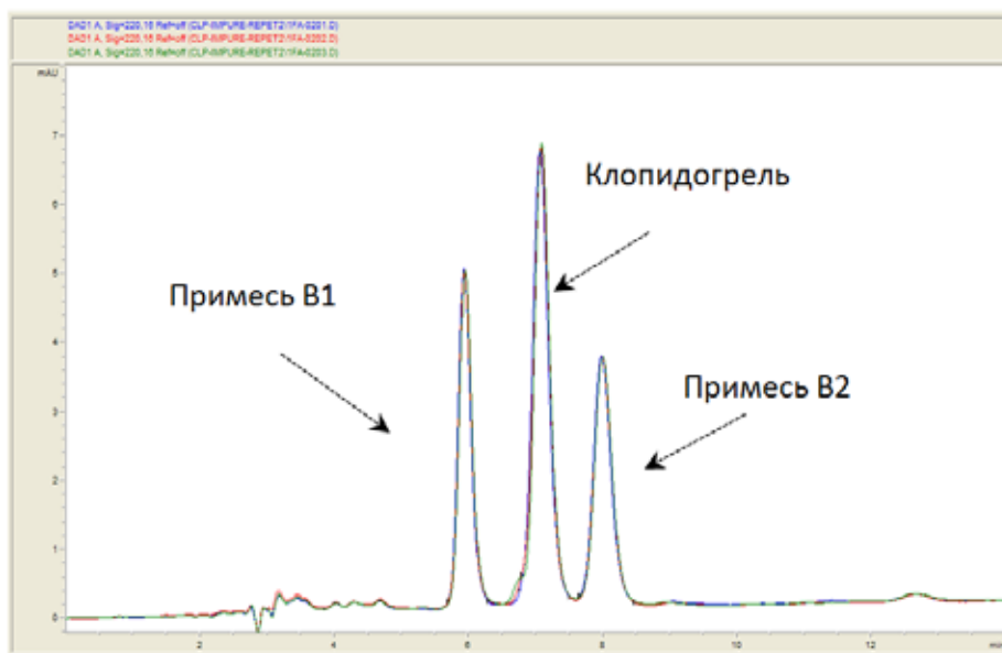
Рисунок 5 – Хроматографическая пригодность разделения клопидогреля и примесей В1 и В2
