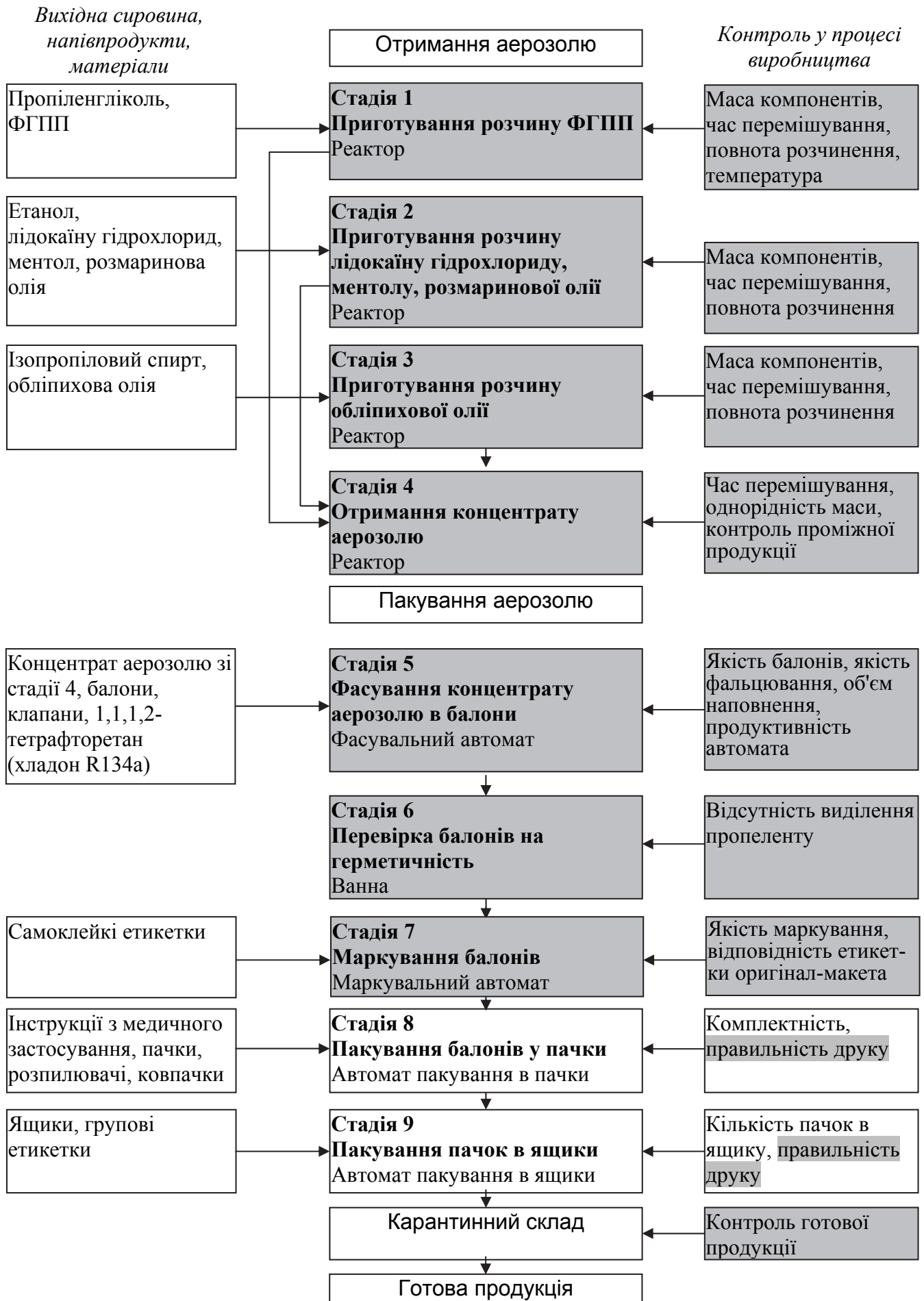
Рис. 3. Блок-схема технологічного процесу виробництва аерозолію «Кріобіозоль»
