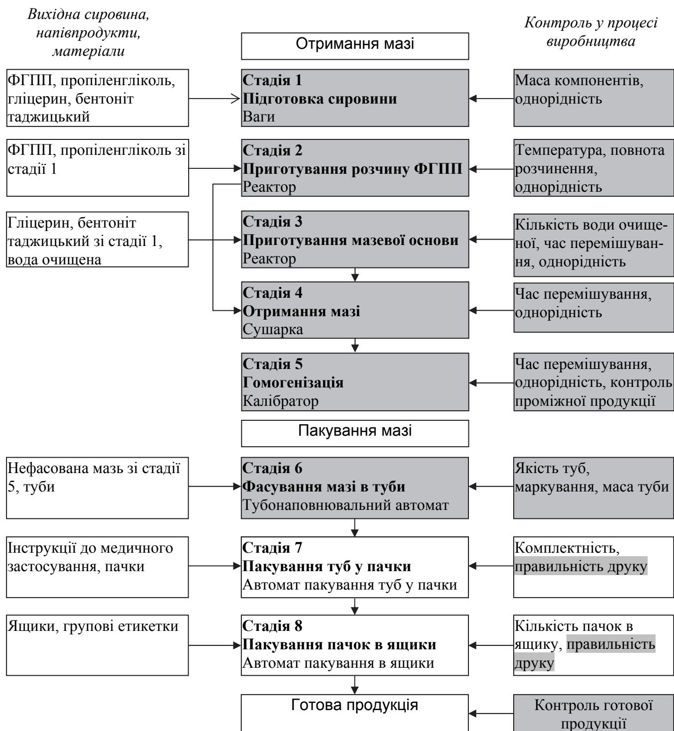
Рис. 7. Блок-схема технологічного процесу виробництва мазі «Протабент»
