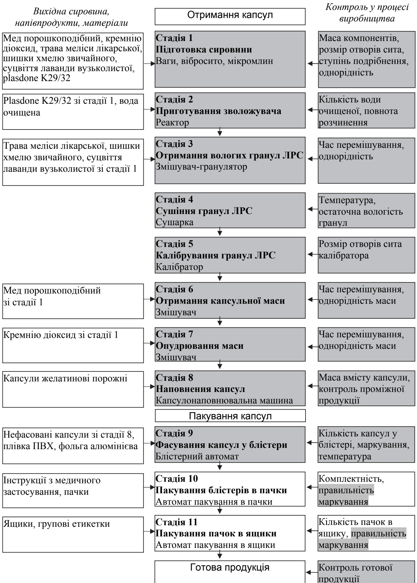
Рис. 2. Блок-схема технологічного процесу виробництва капсул «Апісед»
