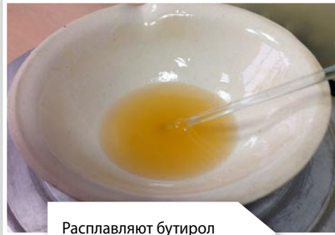
Расплавляют бутирол на водяной бане
