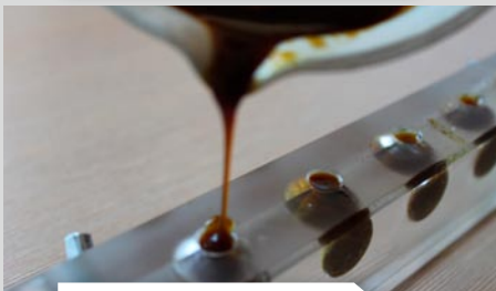
Выливают суппозиторную массу в форму и охлаждают
