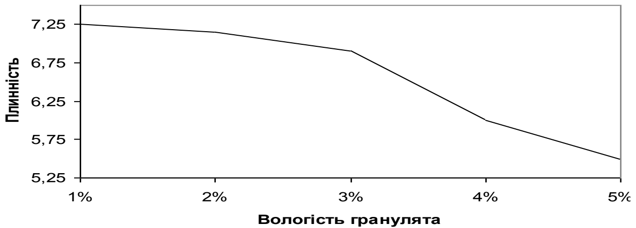
Рис. 1. Залежність плинності від вологості гранулята
