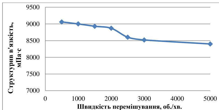
Рис. 3. Залежність структурної в'язкості від швидкості перемішування
