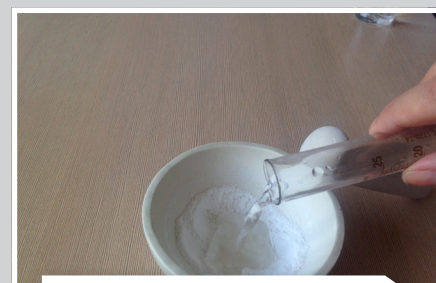
Добавляют воду к мочевины и диспергируют
