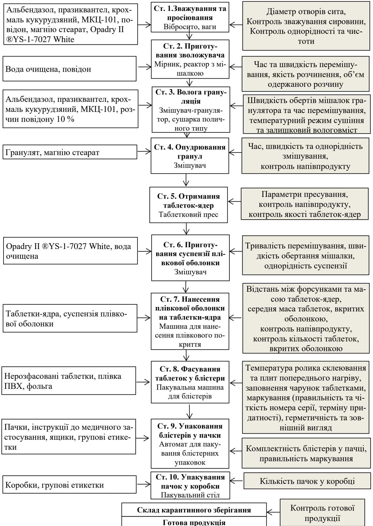
Рис. 1 Технологічна схема виробництва таблеток, вкритих оболонкою, під умовною назвою «АП-гельмін»
