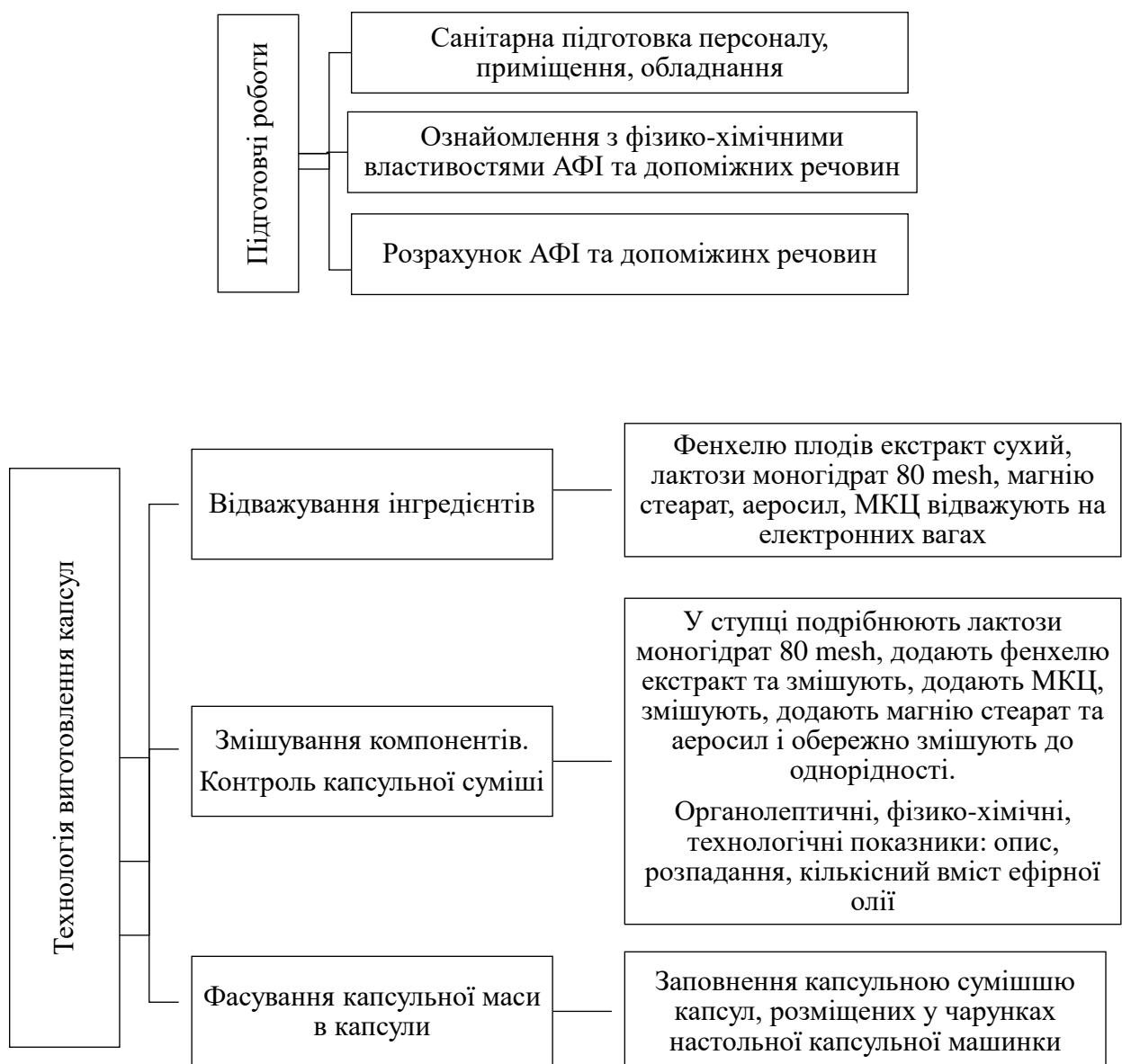
Рис. 5.6 Технологічна схема виготовлення капсул із фенхелю звичайного плодів екстрактом сухим в умовах аптеки (початок)
