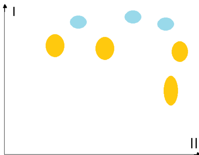
Рис. 2.1 Схема двомірної ПХ ірги канадської Ламарка листя екстракту спиртового. Система розчинників: I – n -бутанол – кислота оцтова – вода (4:1:2), II – 15 % розчин кислоти оцтової.
