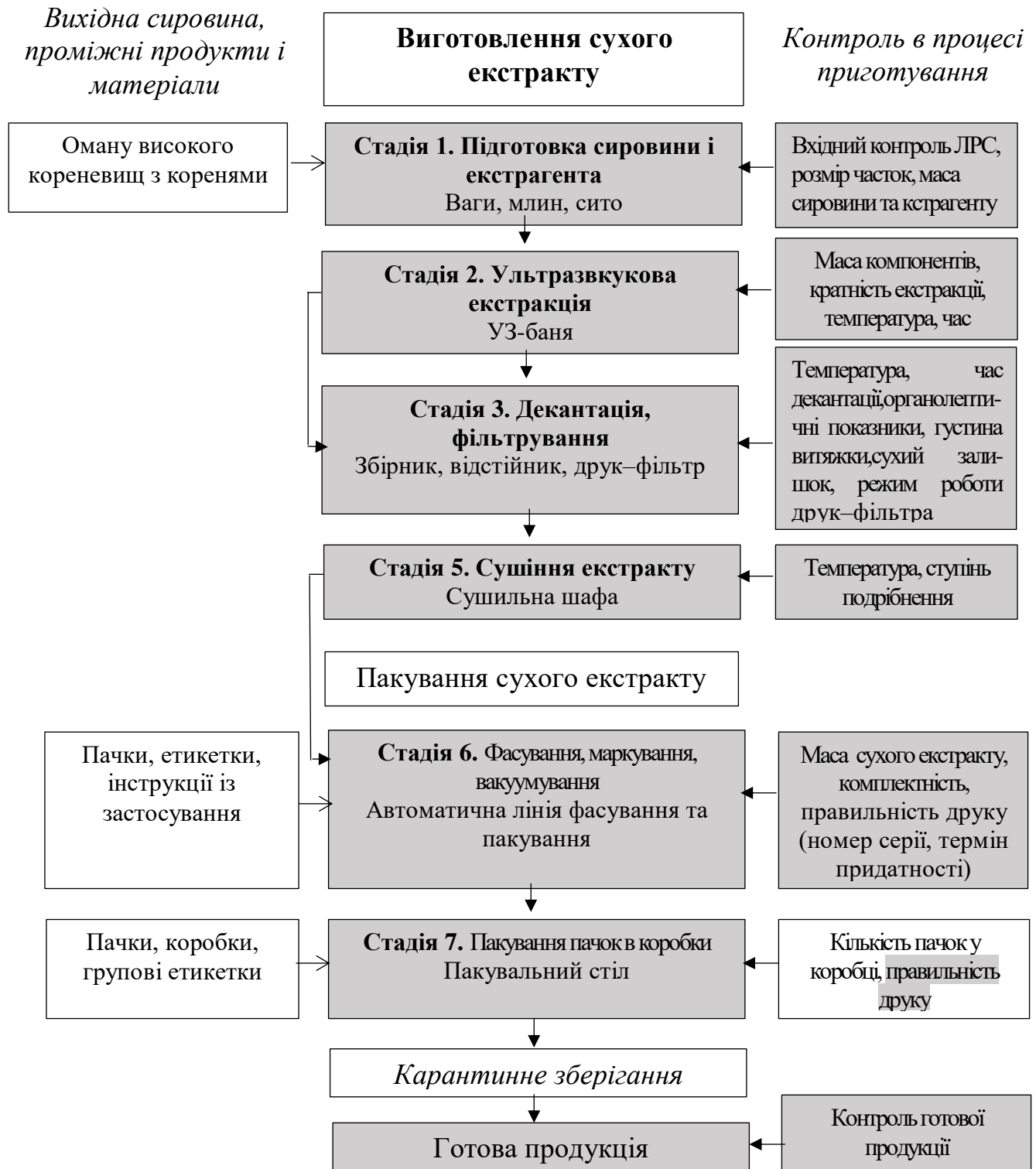
Рис. 3.4 Технологічна схема виробництва сухого екстракту оману високого кореневищ з коренями
