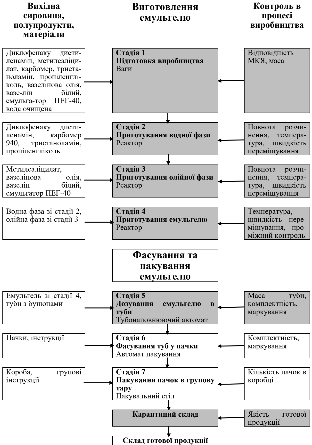
Рис. 3.6. Технологічна схема виготовлення емульгелю
