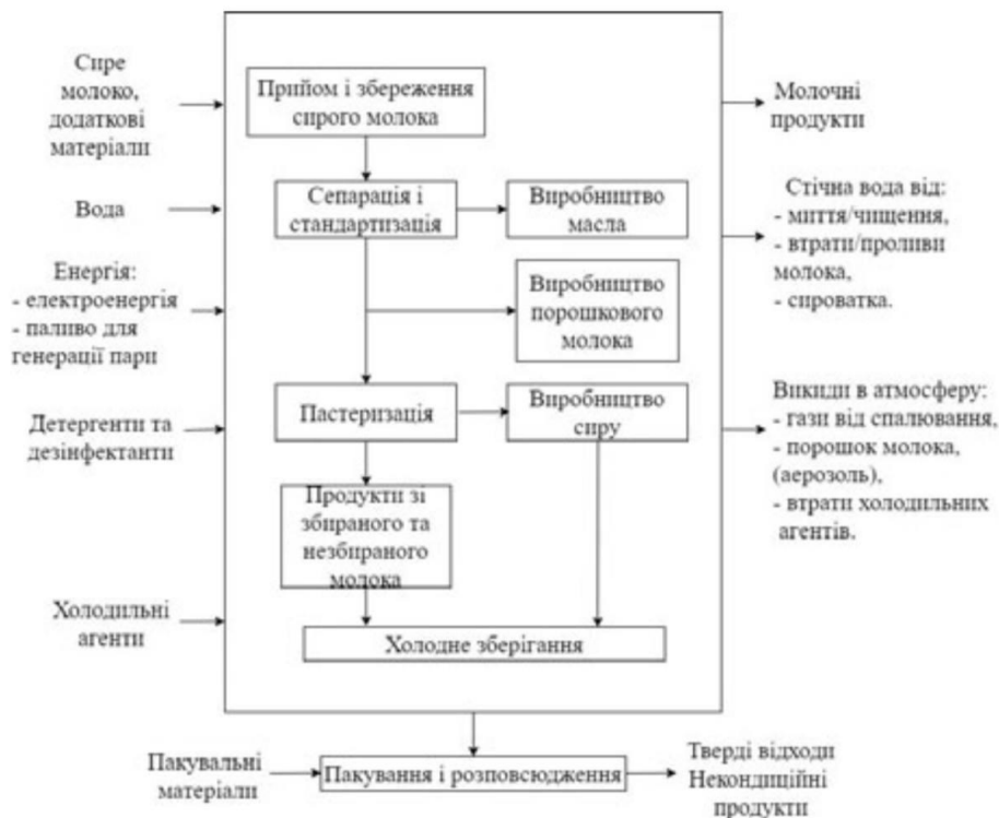
Рис. 5.1 - Узагальнена схема вхідних та вихідних потоків ресурсів у виробництві молочної продукції
