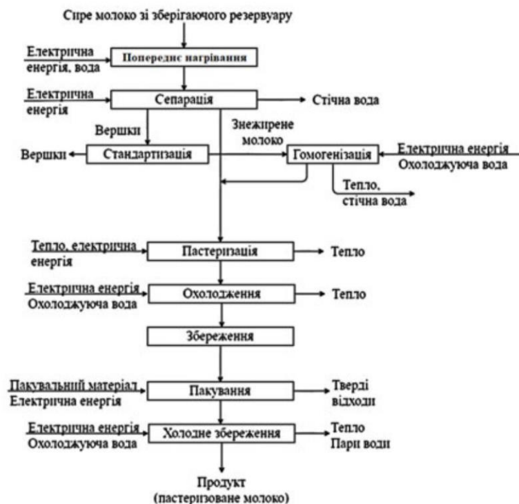
Рис. 5.3 -Типова схема виробництва питного молока в Європі.
