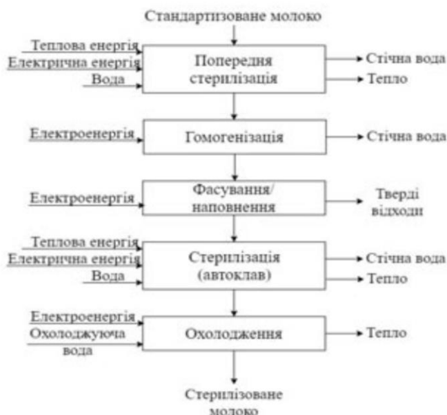
Рис. 5.4 - Схема виробництва стерилізованого молока
