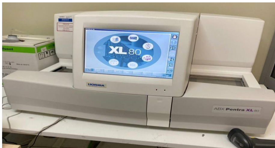
Малюнок 2.1 Автоматичний гематологічний аналізатор ABX Pentra XL 80.
