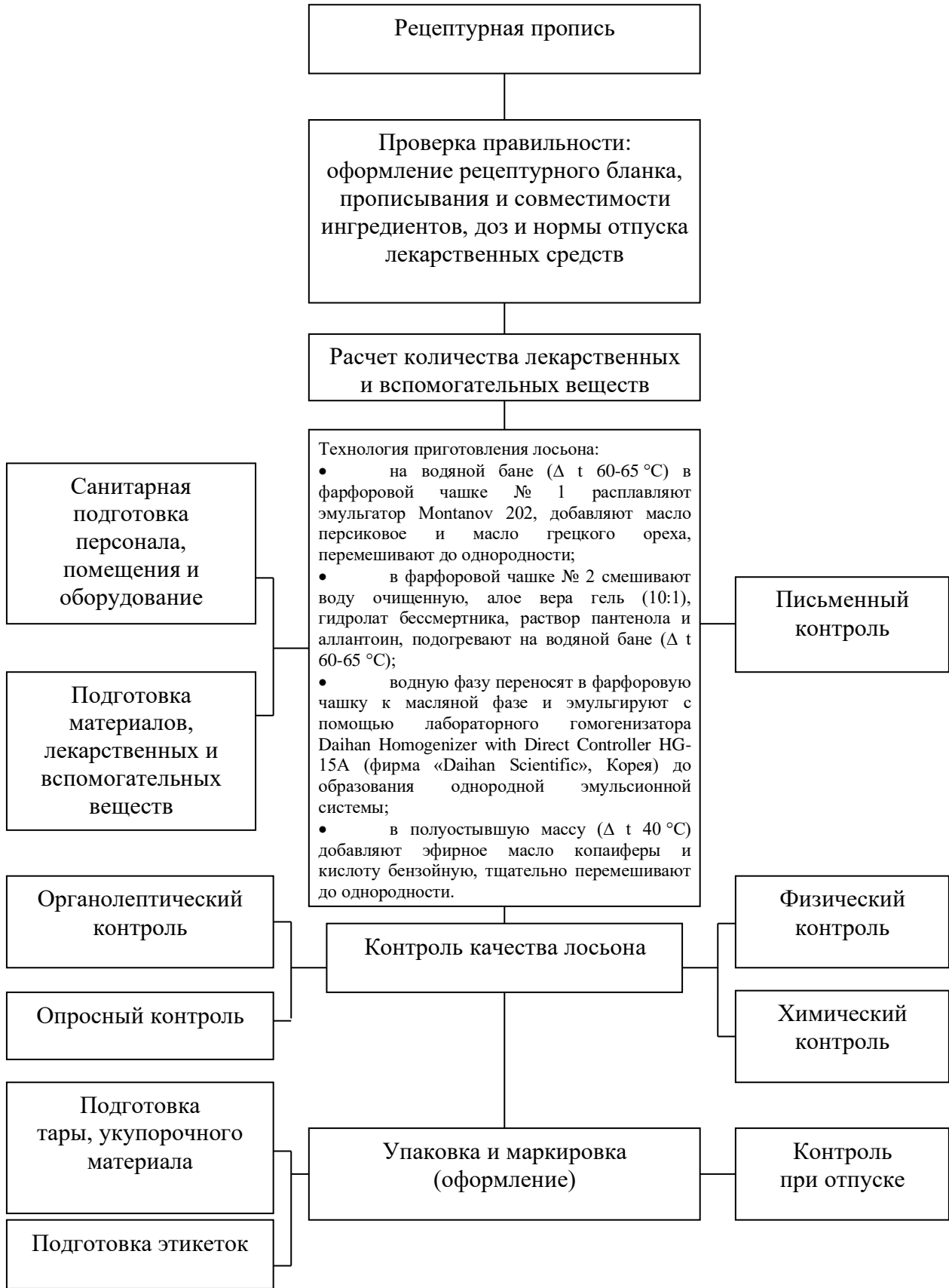
Рис. 3.4. Блок-схема технологии и контроля качества экстемпорального эмульсионного лосьона по уходу за кожей после загара с противовоспалительным действием
