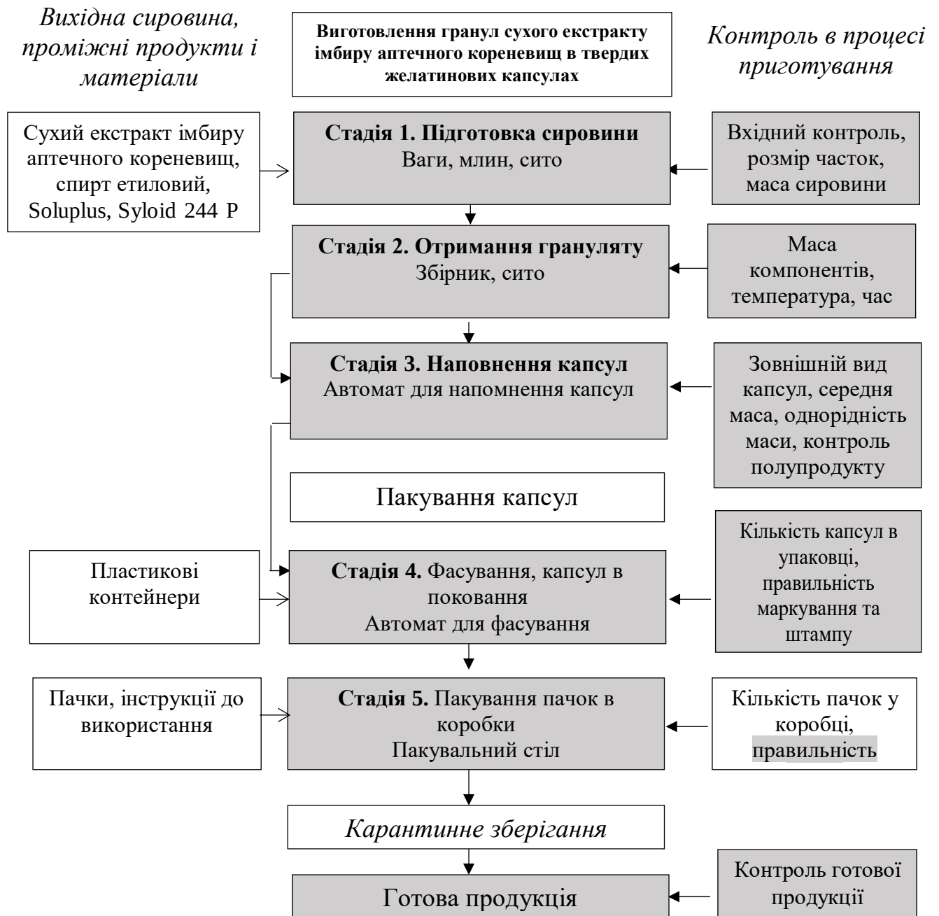
Рис. 3.18 Технологічна схема виробництва гранул сухого екстракту імбиру аптечного кореневищ в твердих желатинових капсулах
