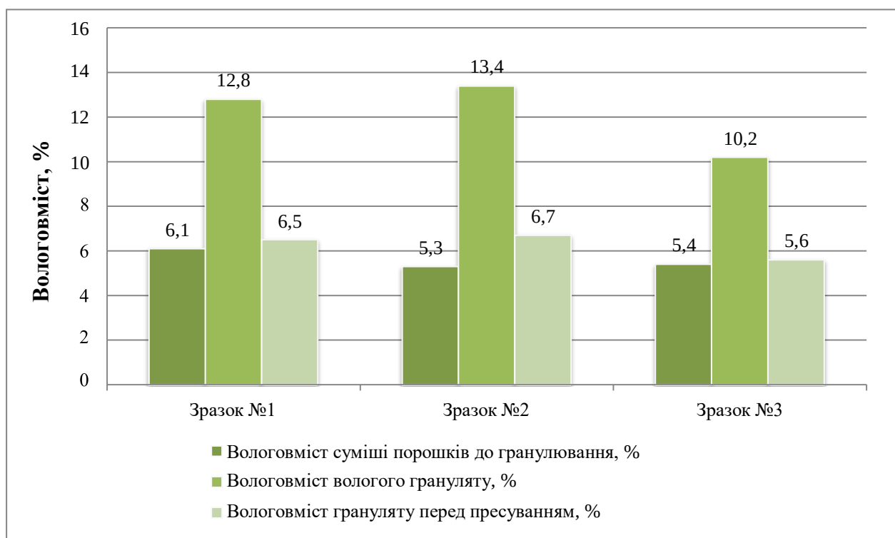
Рис. 3.14 Вологовміст суміші порошків експериментальних зразків 1–3
