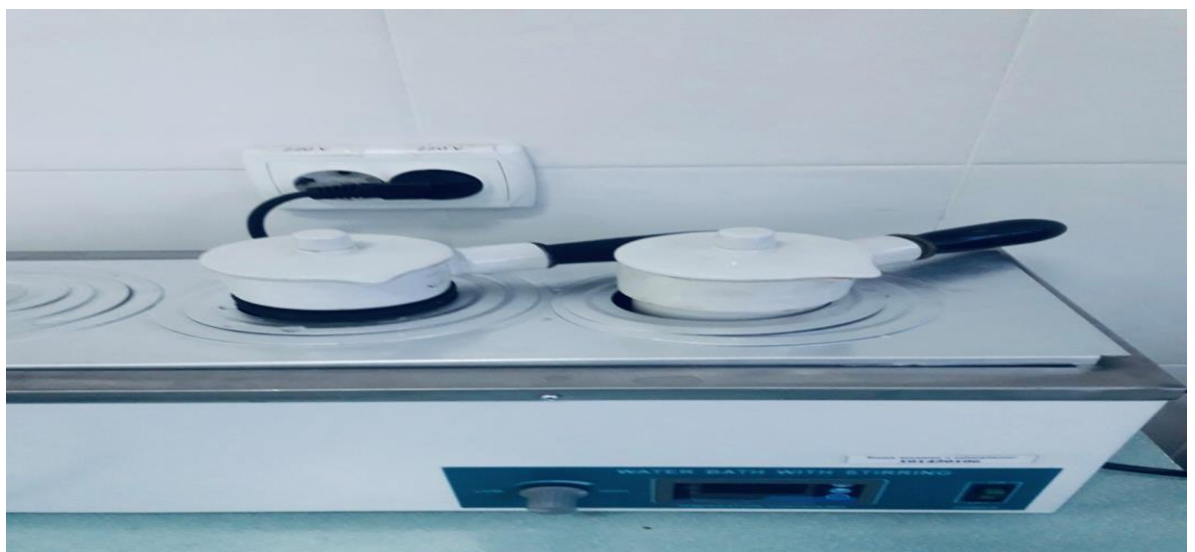
Рис. 2.6 Інфундирний апарат з електричним приводом, водяною банею та регулятором температури
