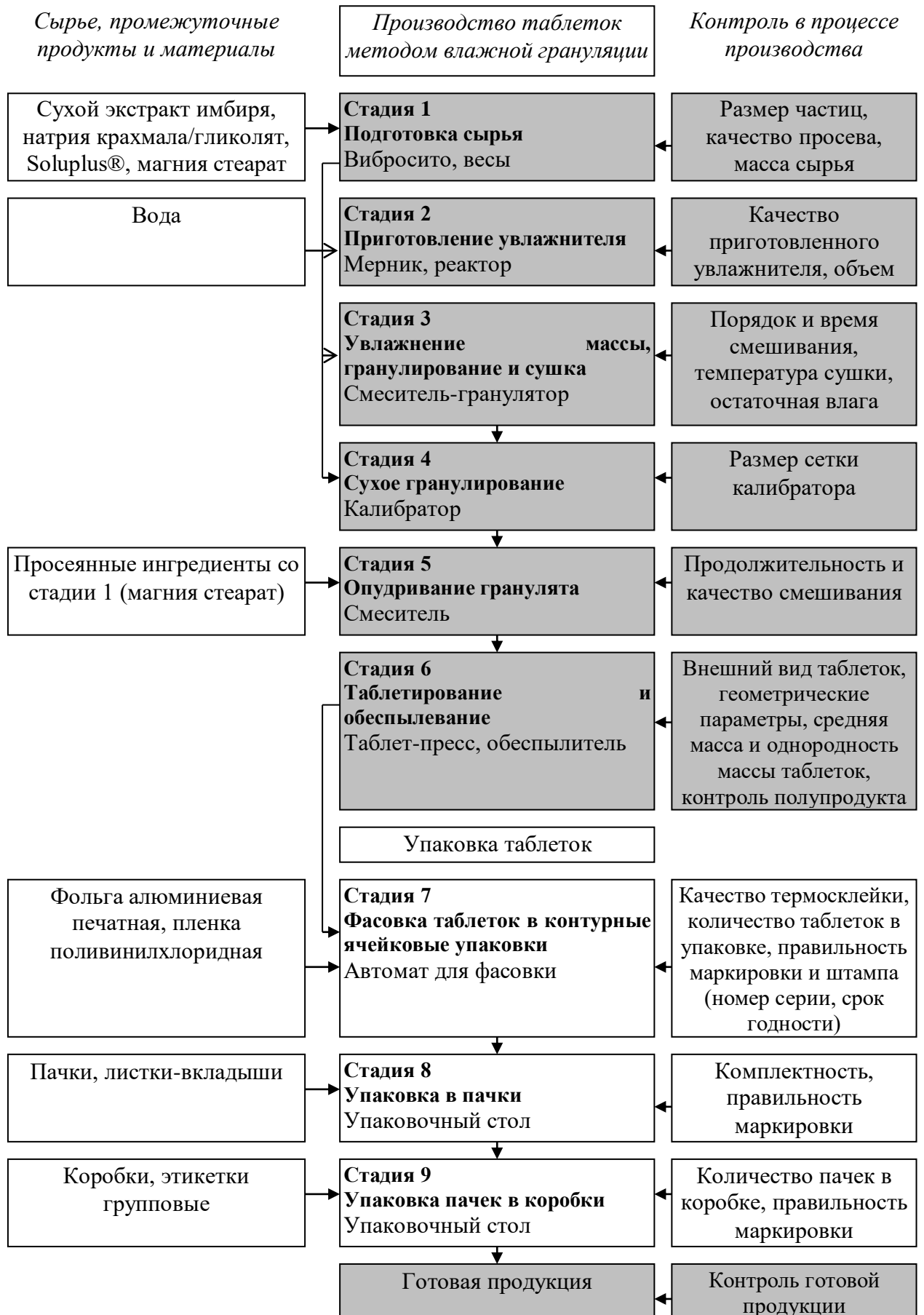
Рисунок 3.6 Технологическая схема процесса производства таблеток с СЭИЛ
