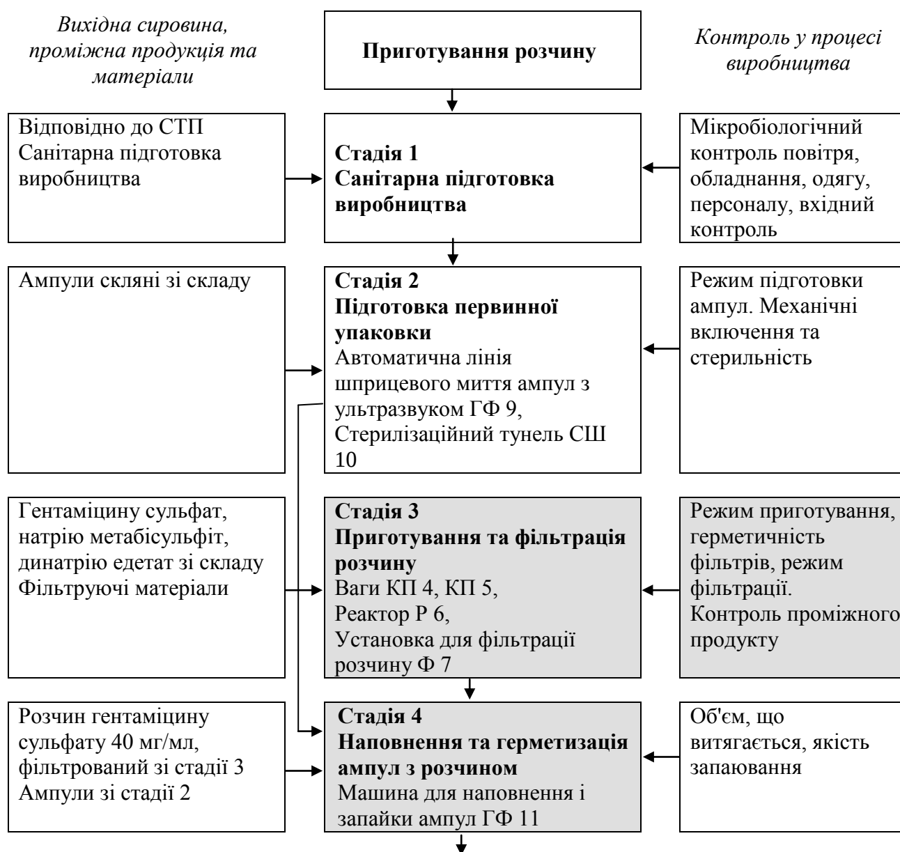
Рисунок 5.1 - Технологічна схема виробництва лікарського засобу «Гентаміцин-Здоров'я», розчину для ін'єкцій 40 мг/мл по 2 мл в ампулах № 5х2 у блістері у коробці.
