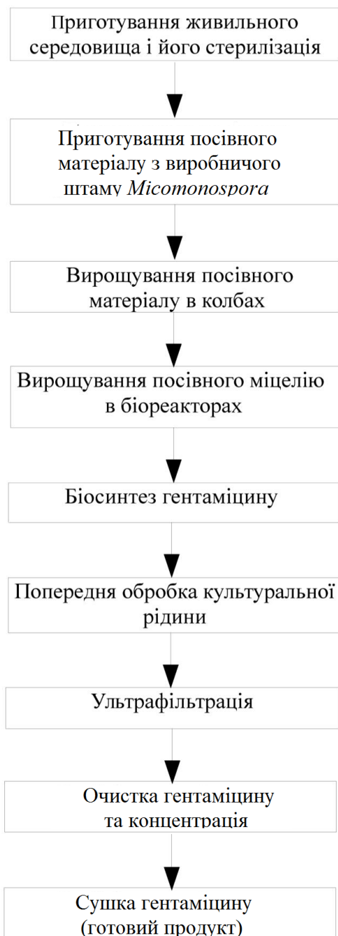
Рис. 2.4. Узагальнена блок-схема виробництва гентаміцину сульфату.
