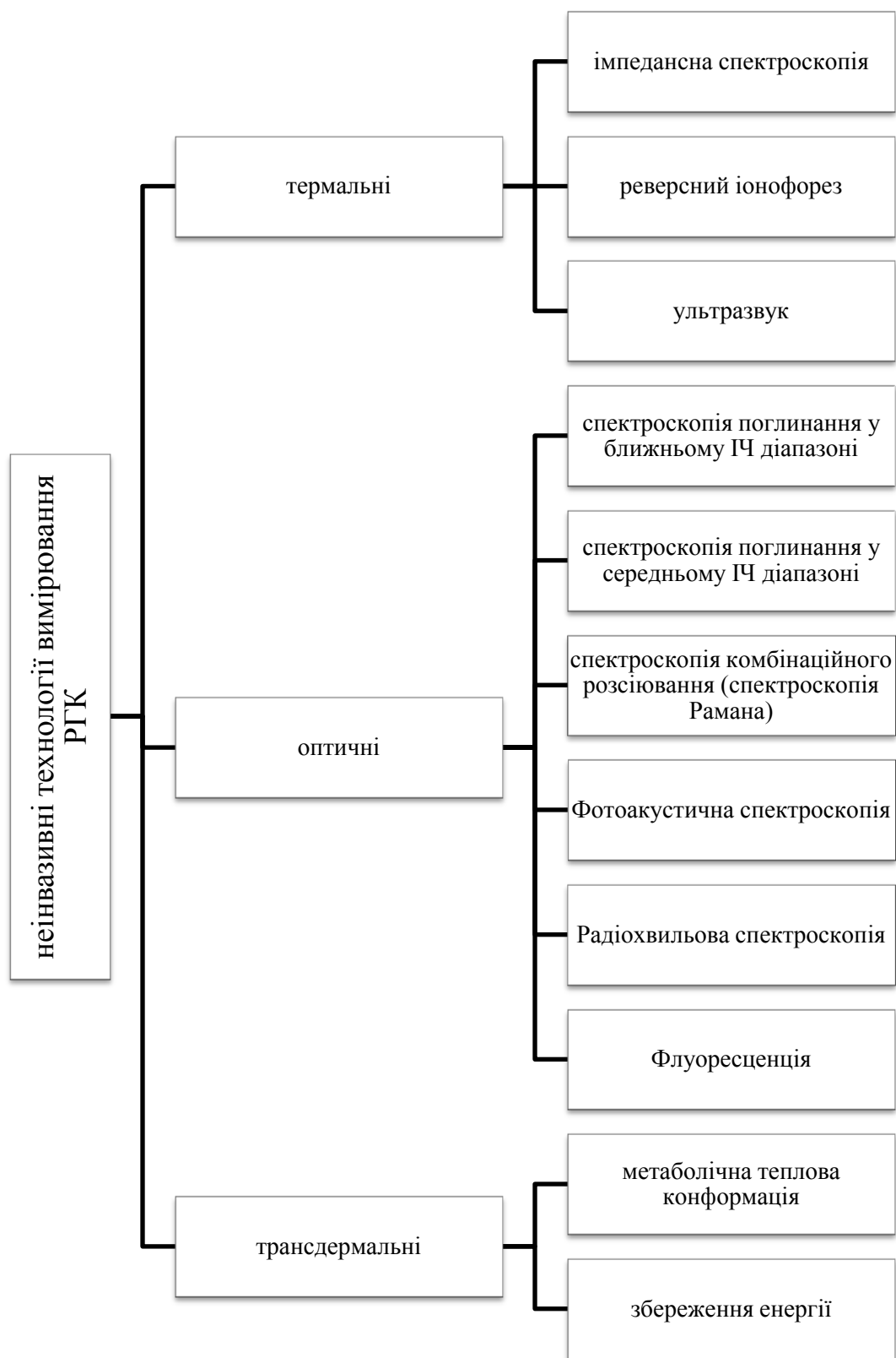
Рис. 1.2 Технологія неінвазивного визначення рівня цукру в крові
