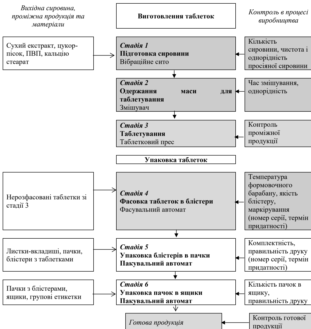
Рис. 3.5 Технологічна схема виробництва таблеток
