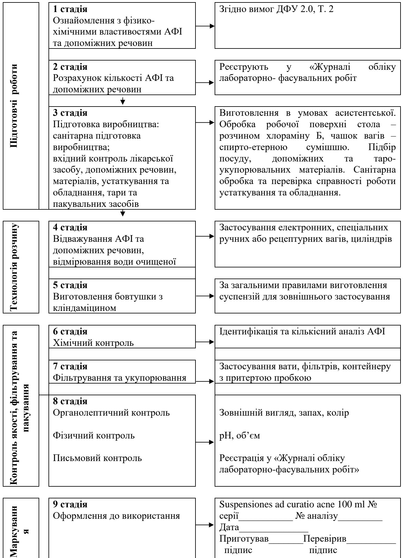
Рис. 3.1. Технологічна схема виробництва бовтушки з кліндаміцином
