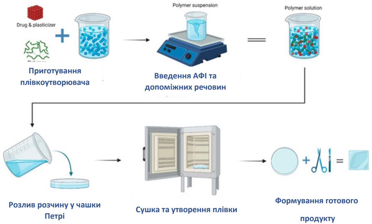
Рисунок 3.1. Схема одержання плівок методом лиття з розчинника.
