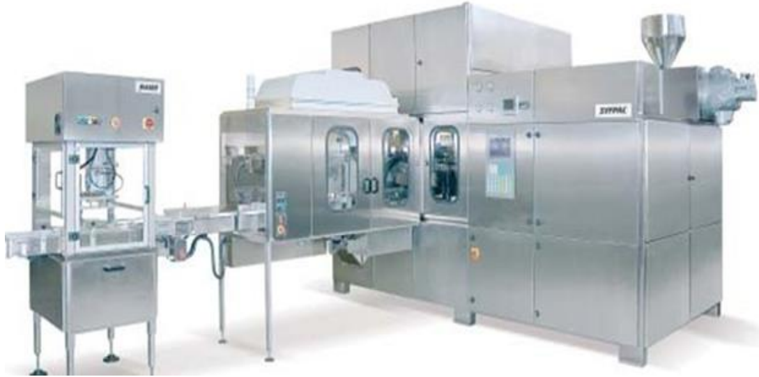
Рисунок 3.8 Обладнання для виробництва полімерних шприців попереднього наповнення в компанії Brevetti Angela S.r.l..
