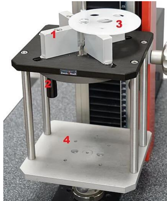
Рисунок 2.4 Механізм для випробування міцності опору при руйнуванні.
