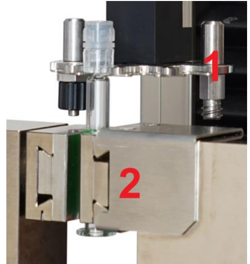
Рисунок 2.10 Механізм для випробування зусилля виривання адаптера замку Люера
