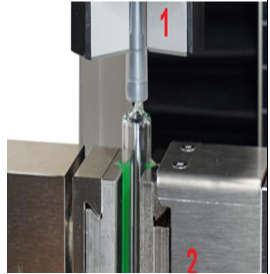
Рисунок 2.13 Механізм для визначення захоплення з 3-кулачковим патроном (верхній).
