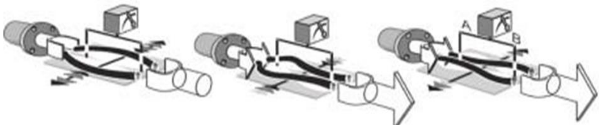
Рисунок 3.13 Наповнення попередньо наповнених шприців за допомогою магнітно – індуктивного методу.
