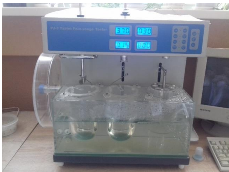
Рис. 2.4 Прилад для перевірки на розпадання капсул
