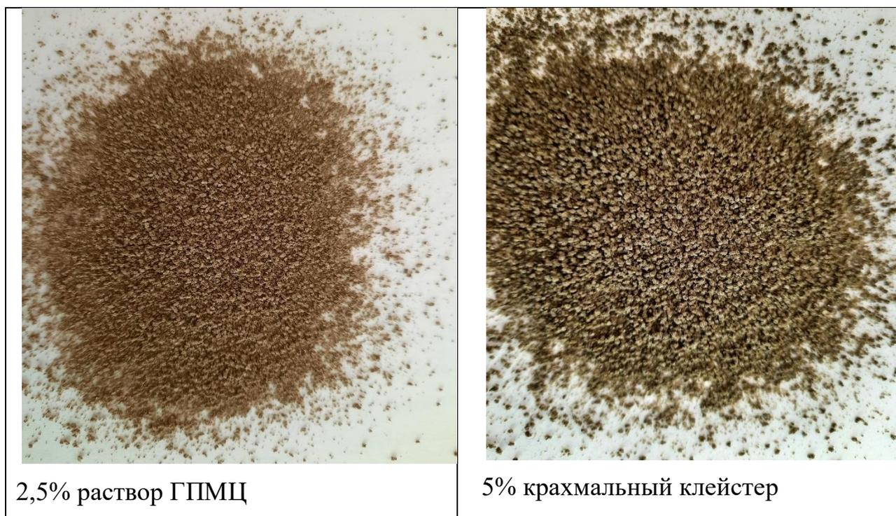
Рисунок 3.4. Внешний вид гранулятов с разным видом увлажнителя
