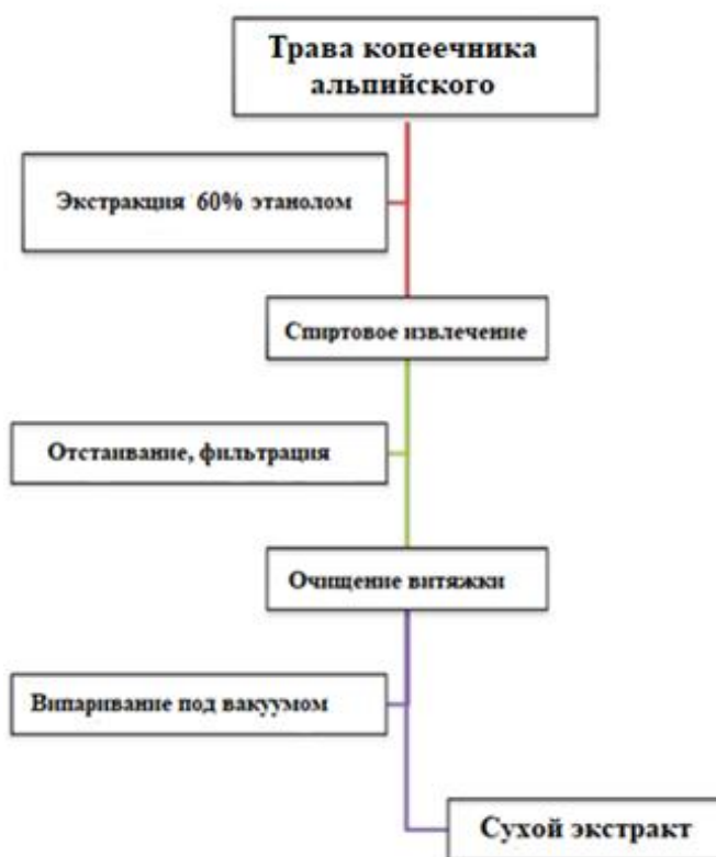
Рис.3.1 Принципиальная схема получения сухого экстракта из травы копеечника альпийского
