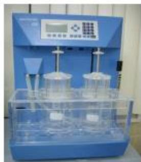
Исследования проводили с помощью прибора «качающаяся корзина» при температуре  $-37 \pm 2^\circ\text{C}$ . В качестве жидкой среды использовали воду очищенную. Корзинка состоит из 6 стеклянных трубок. В каждую трубку помещали по 1 капсуле и включали прибор. В ходе эксперимента контролировали
