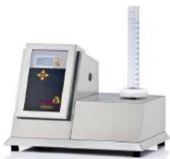
плотность после усадки определяли в градуированном цилиндре на приборе АК - 3. В сухой цилиндр объемом 250 мл помещали 100,0г исследуемого порошка (масса навески). Цилиндр закрепляли на подставке прибора и снимали показания объема до усадки  $V_0$ . После включения прибора начали снимать показания при 10, 500, 1250 подскоках цилиндра и записывали объемы  $V_{10}$ ,  $V_{500}$ ,  $V_{1250}$ . По полученным результатам исследования рассчитывали показатель сжатия и коэффициент Гауснера [3].
