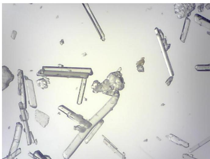
Рисунок 3.3. Микрокристаллическая целлюлоза Pharmasel 102, образцы 3.2-3.3
