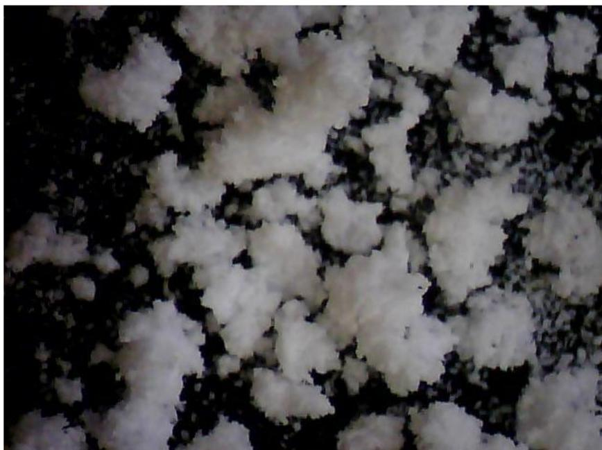
Рисунок 3.2. Безводная лактоза SuperTab 21AN, образцы 2.1 – 2.3
