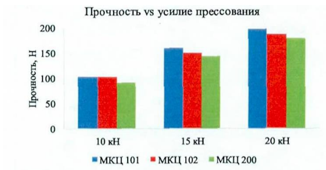
Рисунок 3.7 - Залежність міцності таблеток від зусилля пресування
