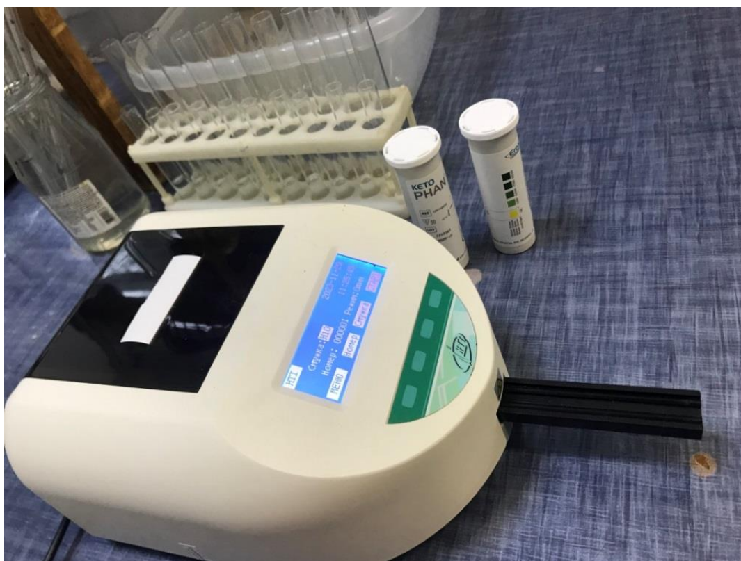
Рисунок 3.3. Автоматичний аналізатор сечі CL-50 та тест смужки UrineRS H10.
