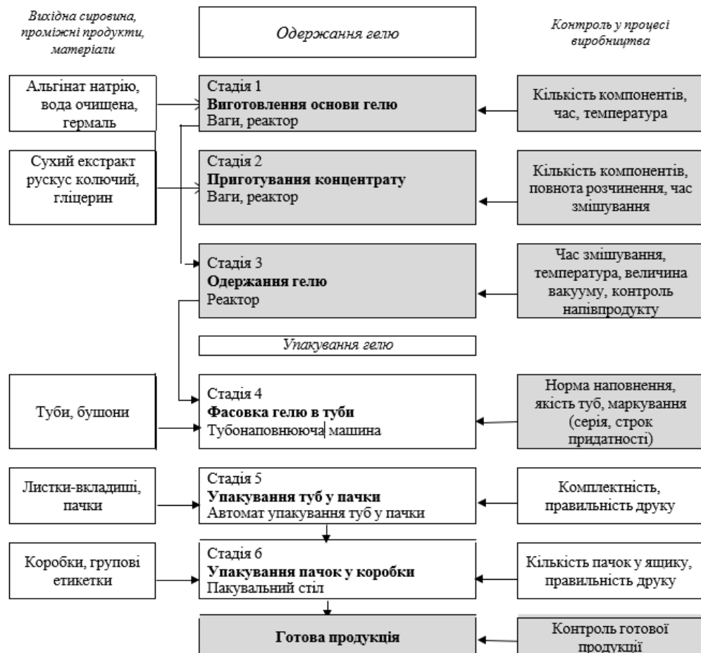
Рис. 3.4. Технологічна схема виробництва гелю з екстрактом сухим рускус колючий
