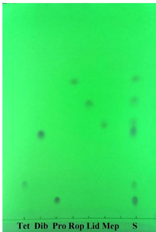
Рисунок 2.2 Тонкошарова хроматограма при проявленні за довжини хвилі 254 нм розділення шести анестетиків зі значеннями R_f 0,09 (Pro – прокаїну г/хл), 0,17 (Tet – тетракаїну г/хл), 0,41 (Dib - дибукаїну), 0,50 (Mer – мепівакаїну г/хл), 0,62 (Lid – лідокаїну г/хл) і 0,73 (Rop – ропівакаїну г/хл), відповідно. Проявна система: система циклогексан-триетиламін (7:3).
