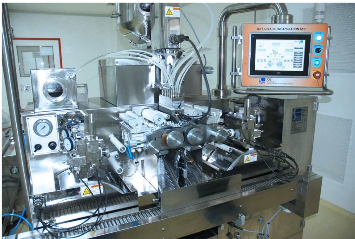
Рис. 1.7 Обладнання для виготовлення м'яких желатинових капсул з наповнювачем
