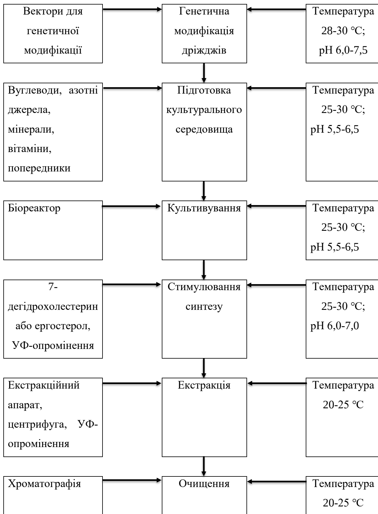
Рис. 1.6 Технологічна схема отримання холекальциферолу з використанням дріжджів Saccharomyces cerevisiae
