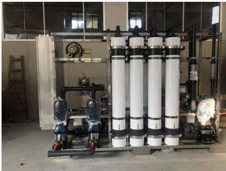
Рис. 1.3. Зовнішній вигляд ультра фільтраційної установки виробництва компанії «Охумо Technology», Китай.
